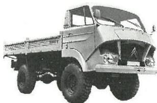
\* Ce châssis 3,30 m est destiné à être équipé d'une citerne pour les laitiers, les pétroliers, les transporteurs de vins et les livreurs de farine en vrac, ciment en vrac, etc. Charge totale supérieure à 8 100 kg.
