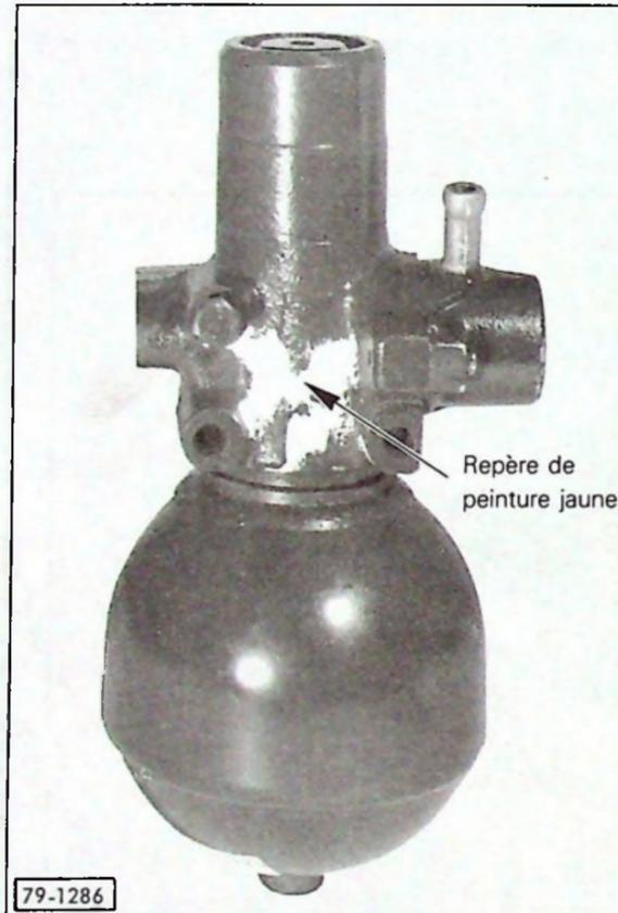
NOTA : Le conjoncteur-disjoncteur repéré « blanc » ( N° PR. 95 547 372 ) monté avec l'avant série de pompe 5 pistons sur Diesel ( Note Technique N° 79-130 MA ) est remplacé par le nouveau ( repère jaune ).
