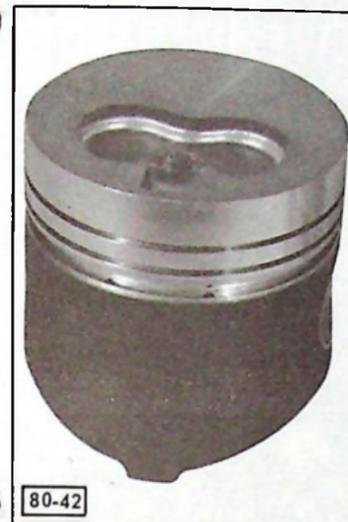
Ces pistons, graphités ( couleur noire ), ont un diamètre de jupe diminué et une nouvelle tolérance du diamètre de l'axe de piston.
