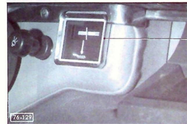
Thermomètre de température d'eau
