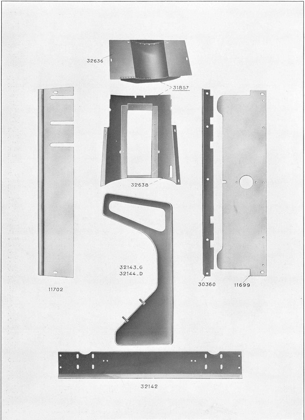
PLANCHER FIXE, PLANCHER MOBILE, SUPPORTS — COQUILLE DE RÉSERVOIR
