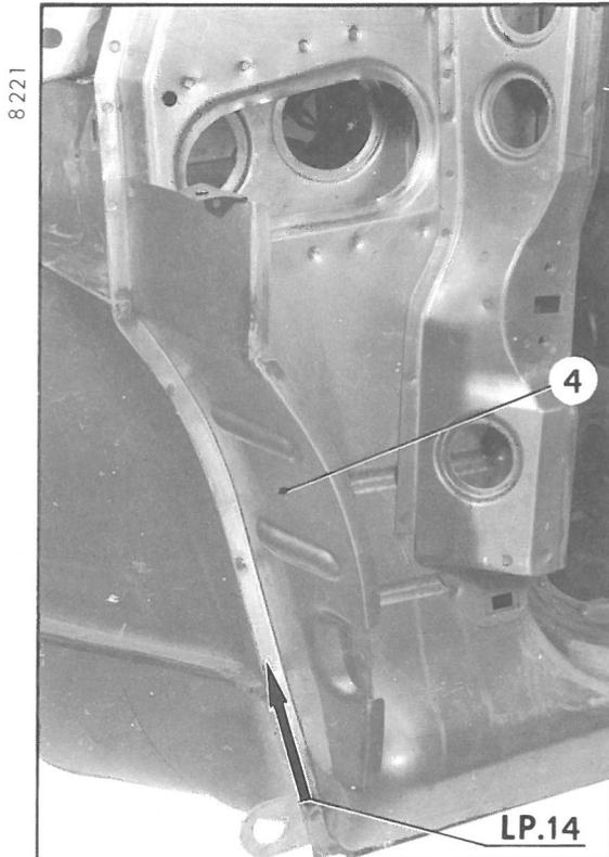
19. Mit elektrischen Schweisspunkten zusammensetzen :
