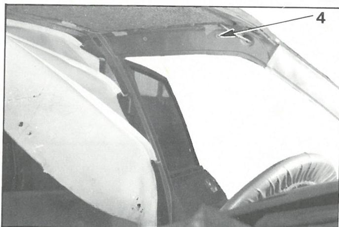
7. Querspanner in entsprechende Hülle einsetzen.
