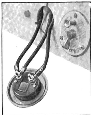
*Fig. 360.* — Branchement des câbles de l'ampèremètre.
